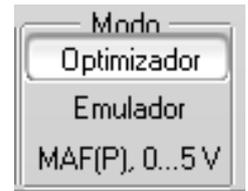
Este modo se utiliza para la creación de la señal de la sonda lambda de circonio (incluso en caso de su ausencia). Para la recreación (emulación) de la señal se utilizan los datos sobre la cantidad de aire que llega al motor (por ejemplo, de sensor de flujo de aire), cantidad de inyección de combustible y datos, obtenidos en el proceso de aprendizaje. Para obtener la mezcla predeterminada, estos datos se elaboran y se muestran en forma de la señal de la sonda lambda.
