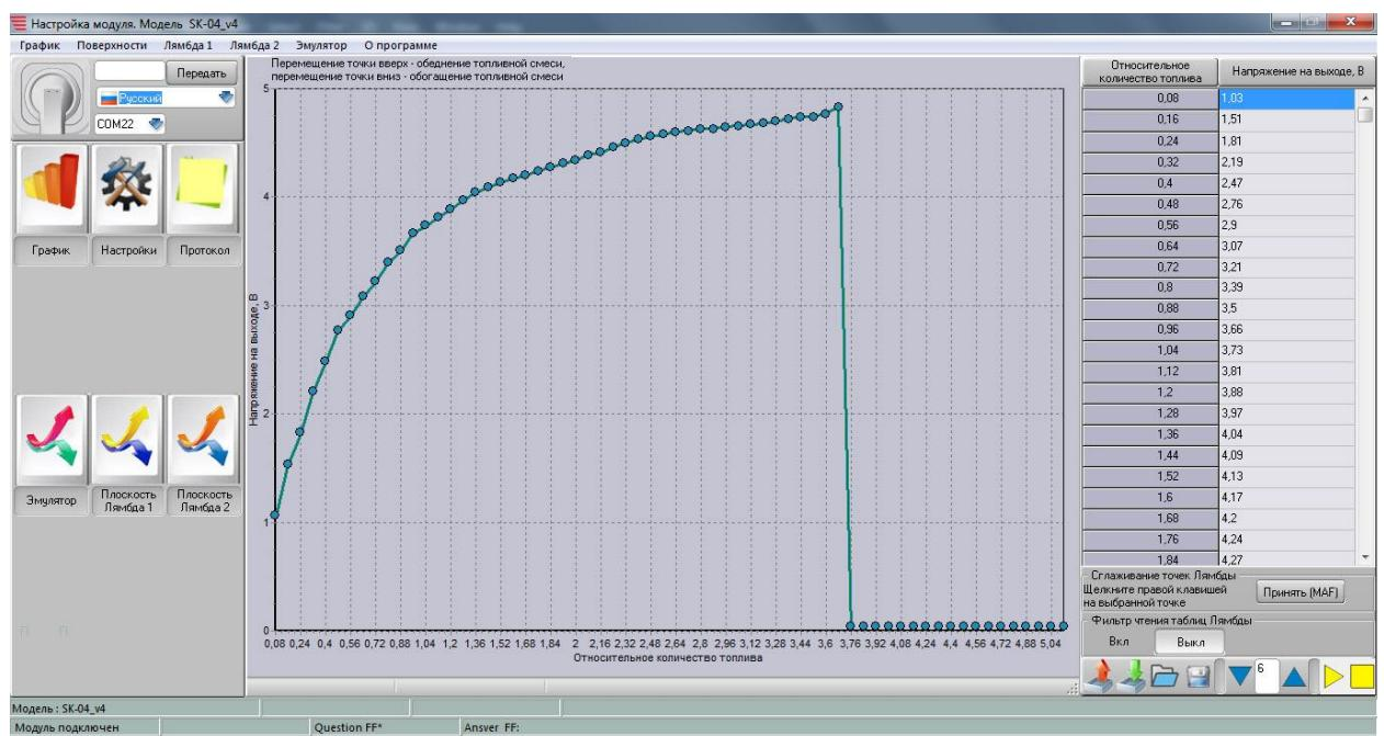
Таблица эмуляции MAF строится на основании количества воздуха (значения в условных единицах). К каждой точке количества воздуха привязывается соответствующее этому расходу напряжение MAF.
