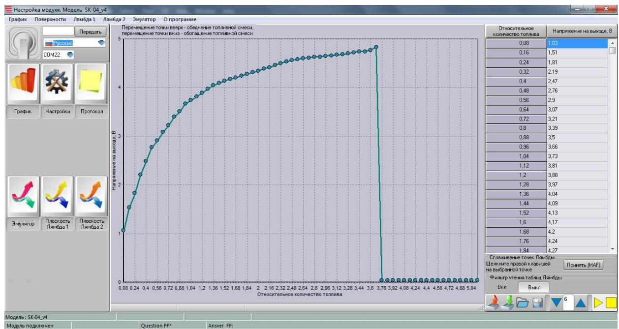
Рисунок. 5.2. Точки и кривые, выводимые на график эмулятора: *желтые – текущие данные; синие – записанные в эмуляторе в процессе обучения; зеленые – отредактированные пользователем.*
