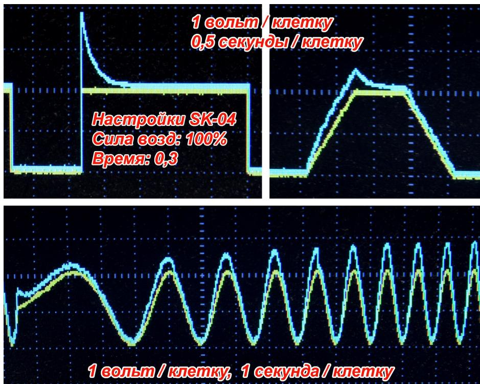
С помощью параметра «время воздействия» можно настроить продолжительность пика (время дифференцирования). Время воздействия указано в перерасчете на прямоугольный входной импульс. Если выбрать 0, то эта функция отключается.
