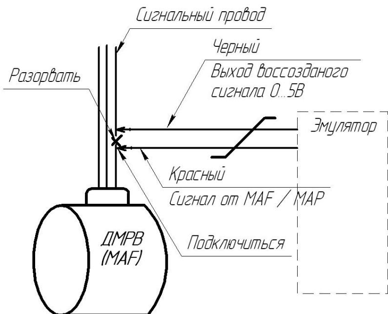
Если у Вас установлен ДМРВ с импульсным выходом, до подключения эмулятора запустите двигатель и измерьте частоту импульсов от ДМРВ на холостых оборотах и при сильных перегазовках (функция измерения частоты есть на многих цифровых мультиметрах). Если частота на каких-либо режимах превысила значение 1000Гц, нужно отметить в настройке «Диапазон частот ДМРВ – более 1КГц».
