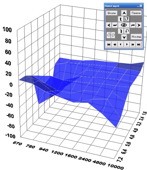
Имеется возможность производить воспроизведение сигналов в зависимости от частоты вращения, времени впрыска, расхода воздуха. Таблица коррекции построена в виде матрицы 8x8. Столбцы матрицы всегда соответствуют частоте вращения. Строки матрицы соответствуют времени
