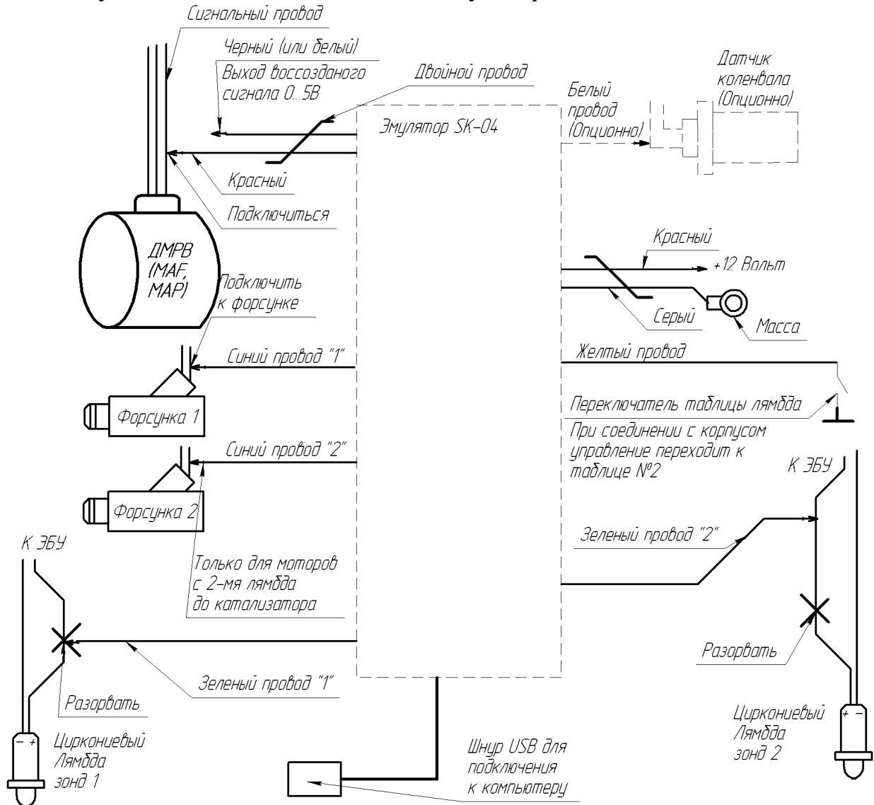
Подключаем питание к системе. Черный провод **обязательно** необходимо подключить к **корпусу ЭБУ** (блока управления) или к корпусу автомобиля вблизи ЭБУ. Питание 12 вольт можно взять с блока предохранителей автомобиля или с питающего провода форсунки. При подключении от колодки предохранителей нужно найти такой предохранитель, на котором напряжение присутствует только при включенном зажигании, затем подключить красный провод к этому
