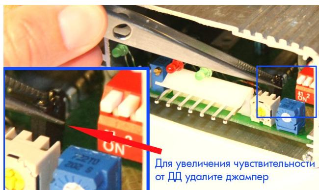
Рисунок 3.6. Увеличение чувствительности от датчика детонации.
