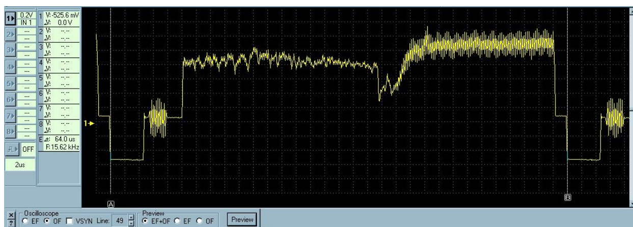
Рис. 6 Окно программы отображающее видео сигнал обрабатываемый PlugIn-ом "Video". Панель PlugIn-а отображается в нижнем левом углу экрана.
