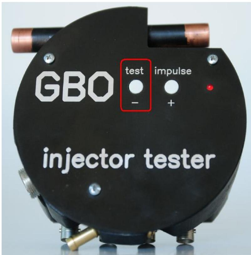
Подождите окончания цикла импульсов. Переключите разъем и шланг на другую форсунку.
