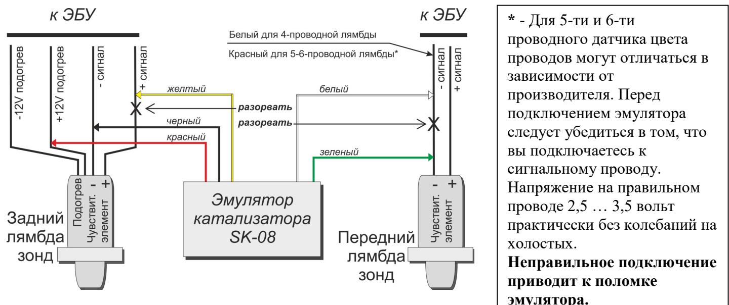
Для правильной работы устройства необходимо, чтобы передний лямбда зонд был в исправном состоянии, так как эмулятор опирается на его показания.
