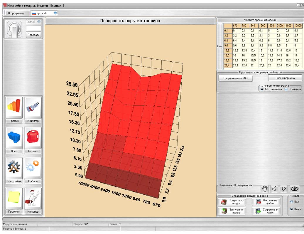
Имеется возможность производить коррекцию сигналов в зависимости от частоты вращения, времени впрыска, расхода воздуха. Таблица коррекции построена в виде матрицы 8x8. Столбцы матрицы всегда соответствуют частоте вращения. Строки матрицы соответствуют времени впрыска топлива или расходу воздуха (напряжение от МАФ (ДМРВ)). Выбор
