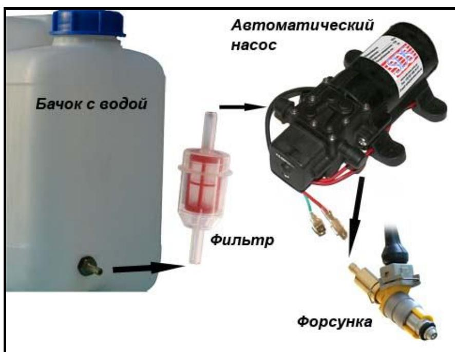
Рисунок 3.2. Схема подключения шлангов в системе с простым насосом.
