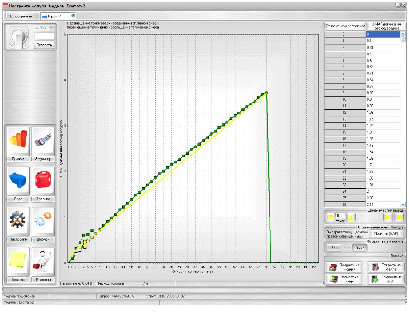
Рисунок. 6.2. Точки и кривые, выводимые на график эмулятора: желтые – текущие данные; синие – записанные в оптимизаторе в процессе обучения; зеленые – отредактированные пользователем.
